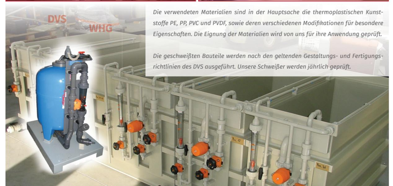
Die verwendeten Materialien sind in der Hauptsache die thermoplastischen Kunststoffe PE, PP, PVC und PVDF, sowie deren verschiedenen Modifikationen für besondere Eigenschaften. Die Eignung der Materialien wird von uns für ihre Anwendung geprüft.
