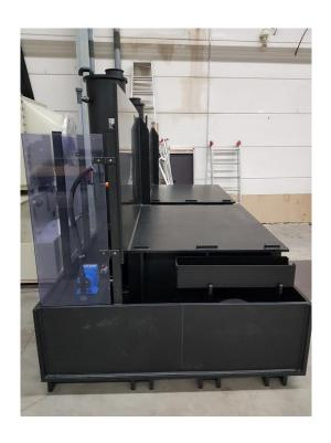
Wanne mit Unterbauung zur Unterfahrbarkeit mit Hochhubwagen und als einfache Transportmöglichkeit zum Verbringen der gesamten Dosierstation mittels Gabelstapler.
